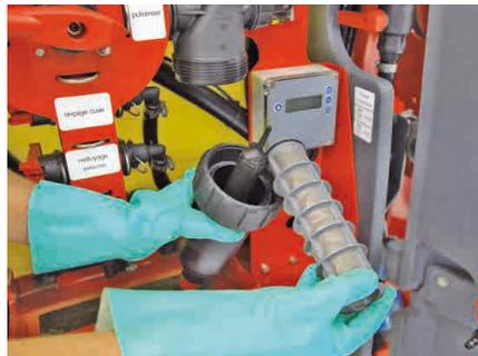
Le filtre de refoulement, auto-nettoyant, prévient tout colmatage du tamis grâce à un flux, modulable, qui renvoie en permanence les impuretés vers la cuve.
