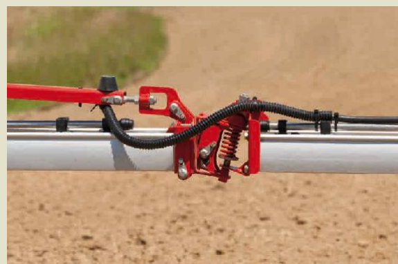
Výkyvně uchycení konce ramen zvýší jejich bezpečnost
