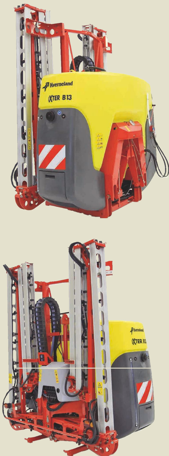
HOSA 15 m "Z" sklopná hliníková ramena
