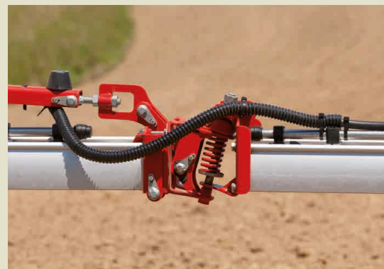
Sécurité en bout de rampe
