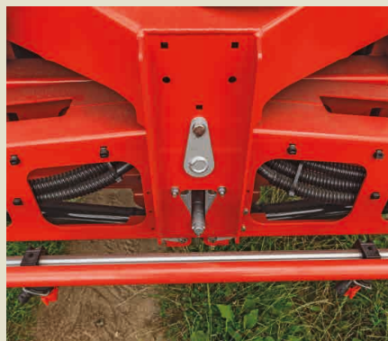
Blocage hydraulique du cadre central
