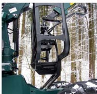
Abnehmbares Stirngitter "Kurzchassis"
