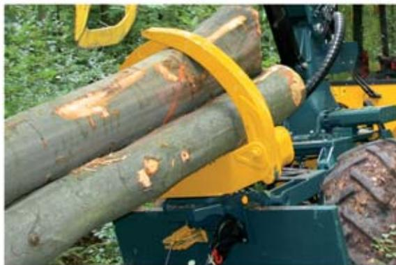
HSM Klemmbank für Forstspeziialschlepper
