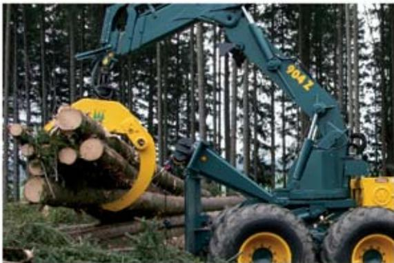
Hochleistungsrückezange mit großem Z-Greifer
