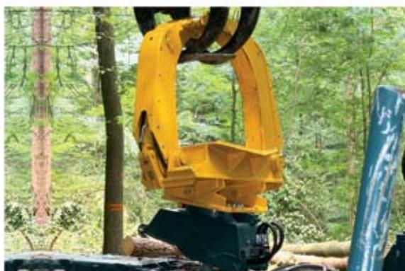
Klemmbank auf Schnellwechselsystem "Kurzchassis"
