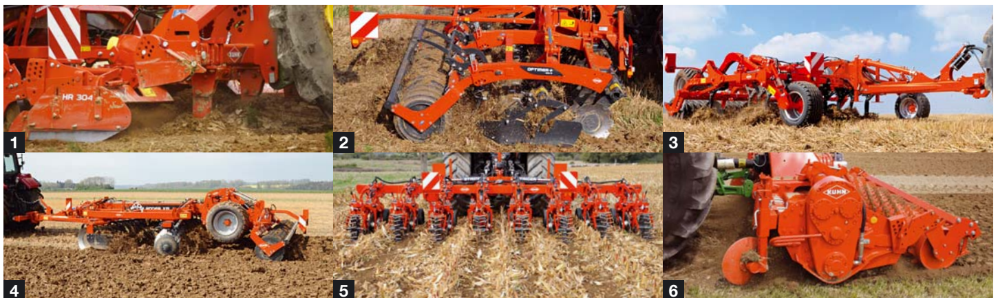
1. Tiefenlockerer - 2. Kurzscheibeneggen - 3. Grubber - 4. Scheibeneggen - 5. Streifenbearbeitungsgeräte - 6. Rotorfräsen
