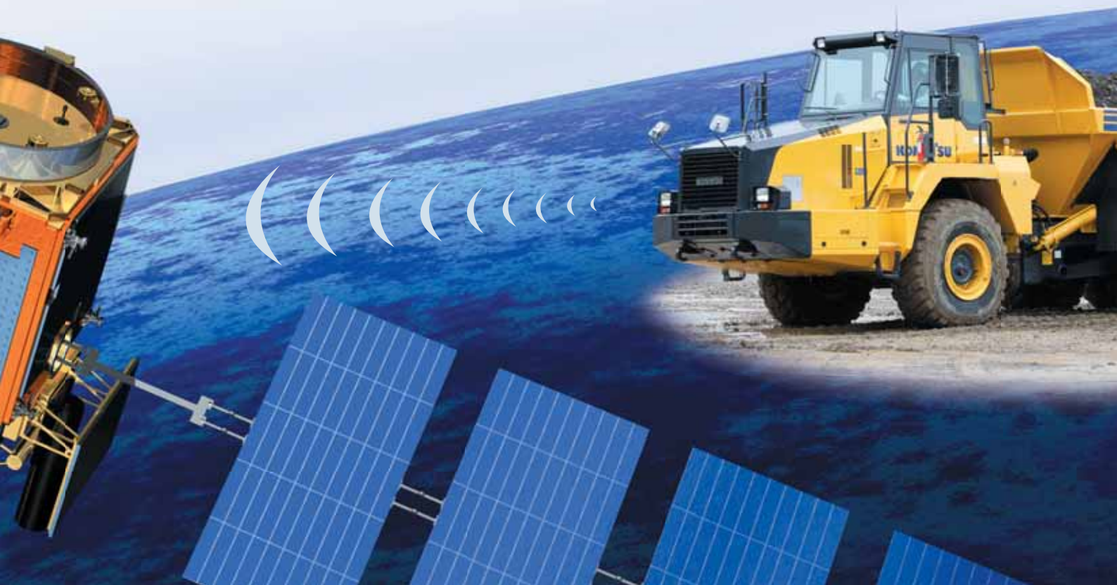
Ekstra sikkerhed - "Motorlås-funktionen" gør det muligt at programmere, hvornår maskinens motor kan startes. Og med "geofence" sender KOMTRAX™ en besked, hver gang maskinen kører ind i eller ud af et forudbestemt arbejdsområde.
