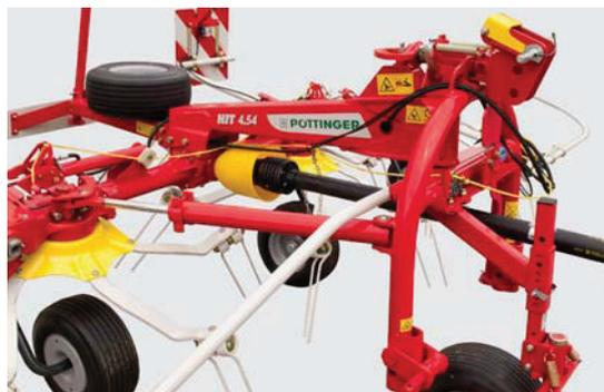
**Diese Zetter mit Arbeitsbreiten (DIN) von 4,40 m und 5,20 m sind besonders kompakt gebaut und für Hanglagen bestens geeignet. Kompaktheit pur. Sechs Zinkenarme pro Kreisel garantieren bei jedem Futter ein optimales Streubild.**
