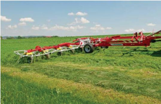
Die gezogenen HIT T Zettkreisel mit zehn oder zwölf Kreisel sind für große Flächen konzipiert. Um dem Wunsch nach großer Arbeitsbreite bei bester Boden Anpassung gerecht zu werden, sind die Kreisel einzeln durch Gelenke miteinander verbunden. Im Zusammenspiel mit dem Fahrwerk als Kreiselführung garantieren HIT T perfekte Arbeit auch bei höheren Geschwindigkeiten.
