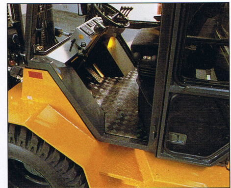
Die gute und ergonomische Gestaltung des Einstiegs verhindert Unfälle beim Ein- und Aussteigen.
