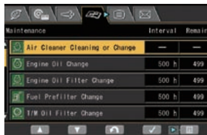
Ein Multifunktionsmonitorsystem ermöglicht die Anzeige und Einstellung von zahlreichen Betriebs- und Wartungsdaten.
