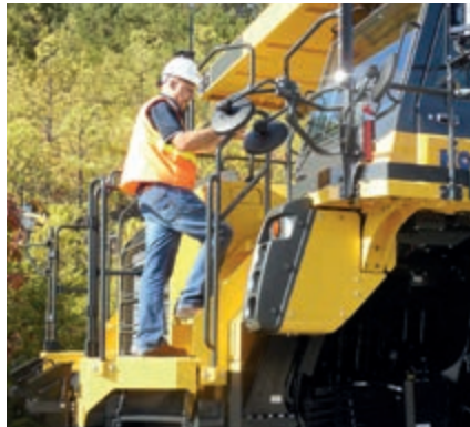
Sicherer Zugang zur Kabine dank der moderaten Steigung der rutschfesten Zugangstreppe mit Handläufen
