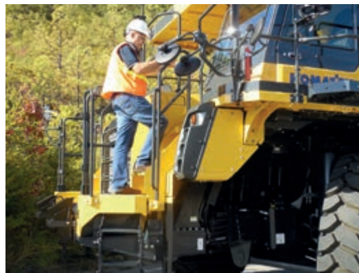
Accès sécurisé et confortable à la cabine grâce à l'escalier avec main courante
