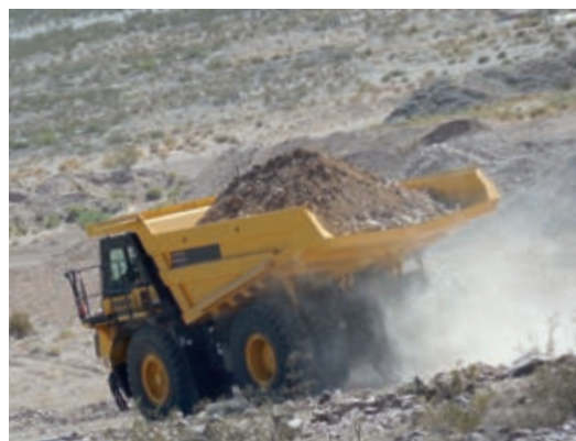
L'ARSC permet à l'opérateur de définir simplement la vitesse de déplacement en descente et de descendre les pentes à vitesse constante.
