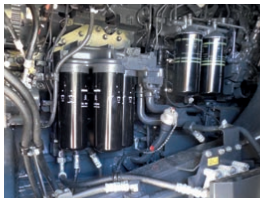
Les points de graissage et les filtres regroupés facilitent l'entretien.
