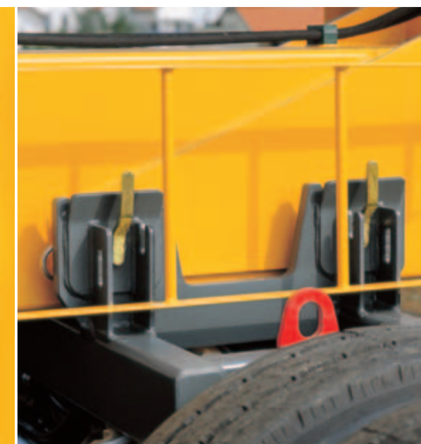
Mit den Schnellverschlüssen können die Achsen leicht an- bzw. abgekoppelt werden.
