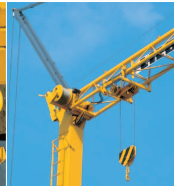
Der polumschaltbare Katzfahrtrieb verfügt über zwei Geschwindigkeiten.
