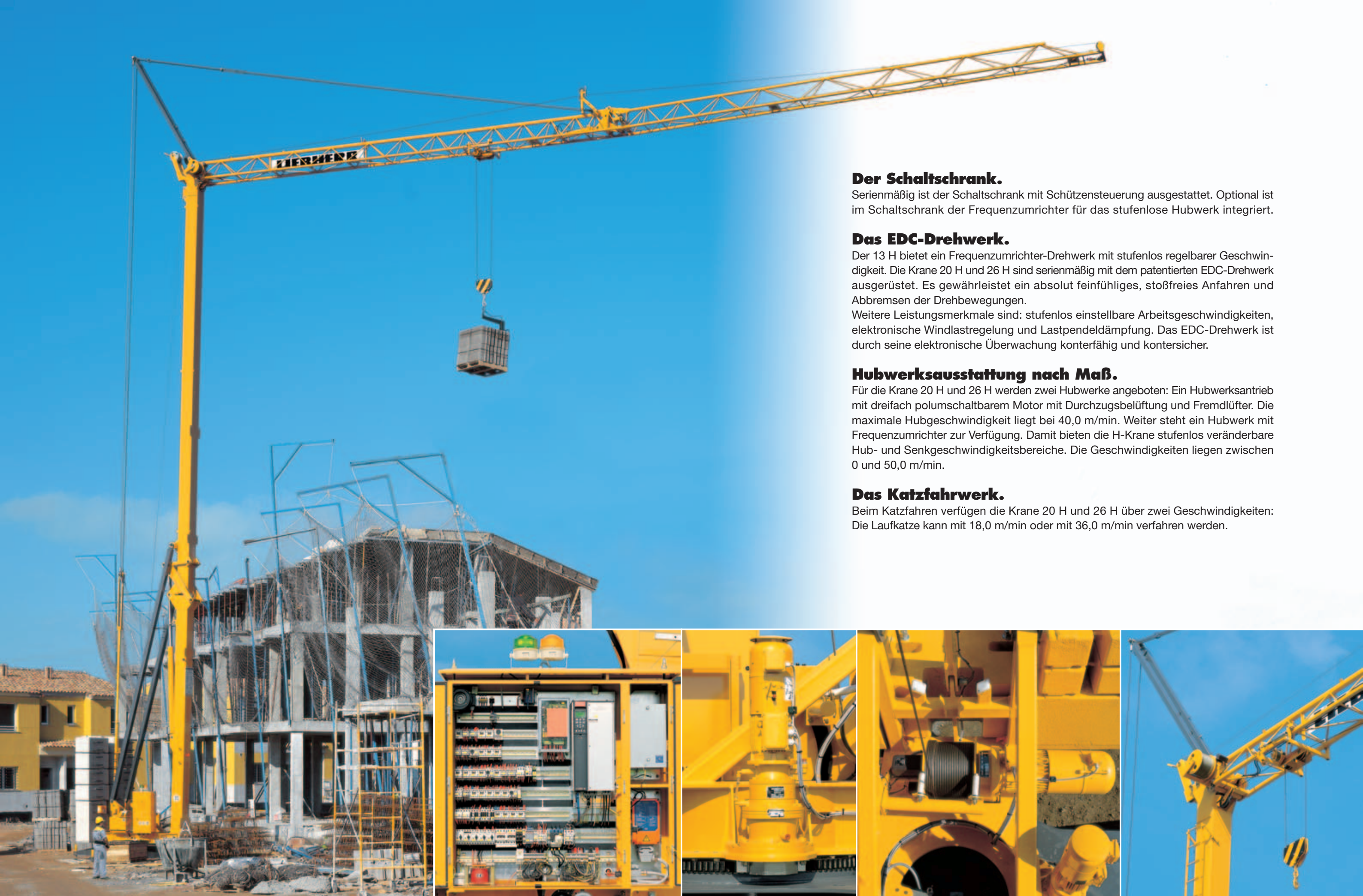
Der Schaltschrank mit Schützensteuerung, EDC-Drehwerks-Controller und dem Hubwerks-Frequenzumrichter.
