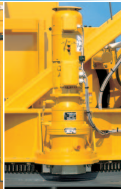
Das patentierte EDC-Drehwerk garantiert feinfühliges und stoßfreie Drehbewegungen.
