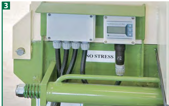
3 Le dispositif électronique "no stress" règle l'alimentation du matériel à broyer, en fonction de la puissance disponible, éliminant ainsi les efforts de force.
