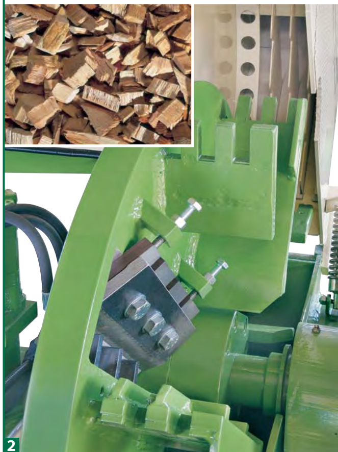
1 Détail sur l'ouverture d'alimentation du matériel. Sur le fond, sont visibles les rouleaux d'alimentation et, en second plan, le disque équipé d'un couteau broyeur. La vitesse des rouleaux peut être réglée par l'opérateur, selon le type de matériel à broyer.
