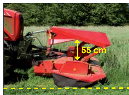
Contour Float – följer jämn mark
