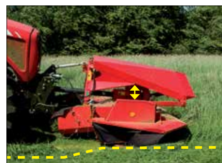
Contour Float – följer ojämn mark
