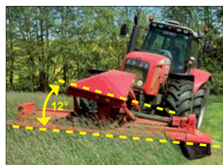
Contour Float – följer i sidled
