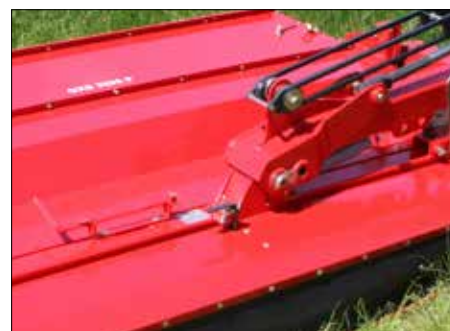
GXS-maskinerna är centrumupphängda vilket ger god markanpassning
