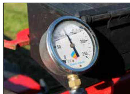
En manometer visar marktrycket
