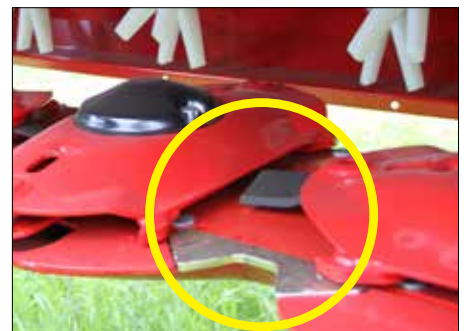
Motstålet är 2 mm högre än rotorbalkens hölje
