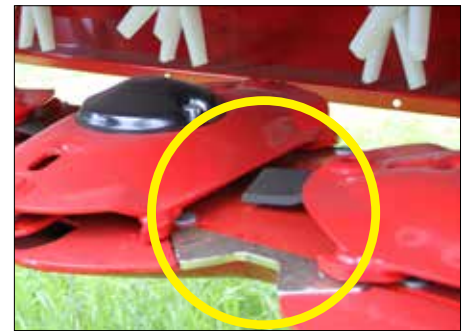
Het tegenmes is 2 mm hoger dan de bovenkant van de maaibalk.
