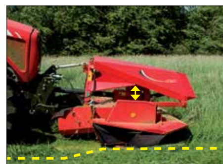
Contour Float – na zvlněném povrchu
