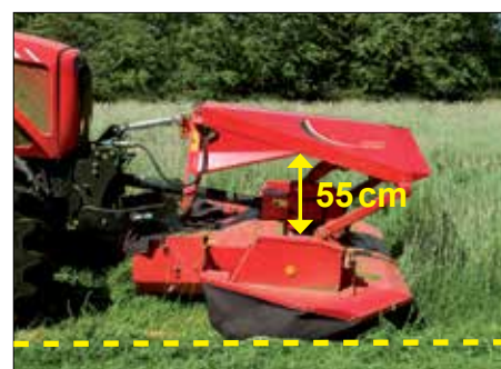
Contour Float – na rovném povrchu
