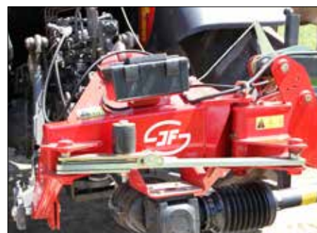
Mechanická ochrana pro případ nárazu
