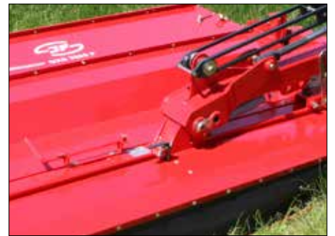
Stroje řady GXS jsou zavěšeny uprostřed, dobře kopírují povrch terénu.
