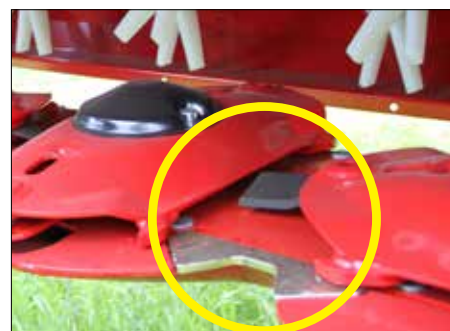
Protiostrří je o 2mm vyšší než kryt žací lišty
