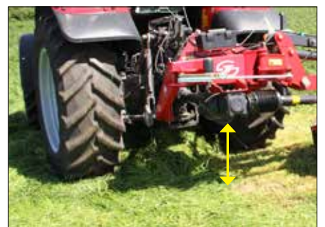
Velká světlost pod převodovkou.
