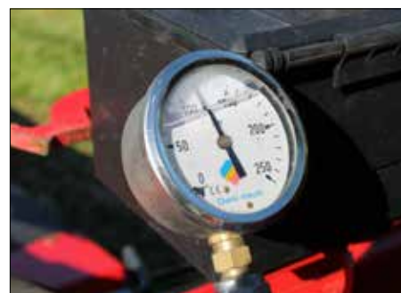
Manometr ukazuje nastavený přítlak na půdu
