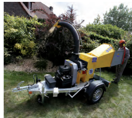
ZUSAMENKLAPPBARER Einfülltrichter für den Transport.
