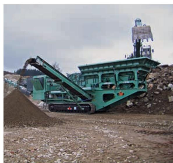
GIPOREC R130 FDR mit Vorabsiebung und Seitenaustrag / with pre-screening and side discharge / avec précriblage et décharge latérale
