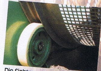
Die Siebtrommel ist auf Schwerlasttragrädern gelagert.
