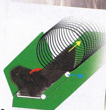
Das Bunkerförderband wird mittels einer automatisch arbeitenden Steuerung permanent im Geradeauslauf gehalten
