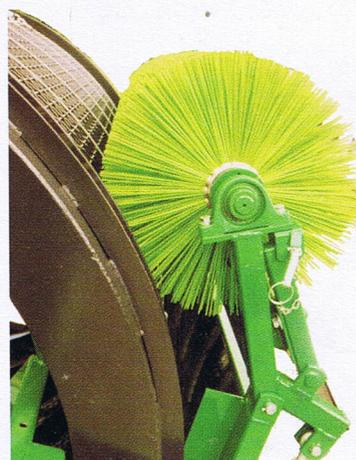
Die Siebtrommel wird mittels einer frei mitlaufenden Rundbürste gereinigt. Die Rundbürste kann mit einem speziellen Abstreifer (Wunschausrüstung) von Störstoffen wie Folien, Bänder etc. gereinigt werden.
