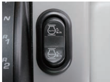
L'accélérateur électrique permet à l'opérateur d'adapter parfaitement le régime moteur aux conditions de travail
