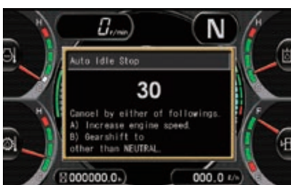
Arrêt automatique réglable en cas de ralenti prolongé
