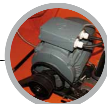
Starker Elektromotor 15 kW
