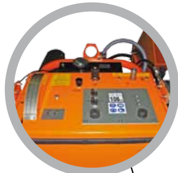
Übersichtliches Bedienpult mit Schnitttiefenanzeige
