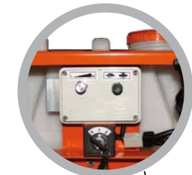
Elektrostart + Steuerpult für Vorschubgetriebe
