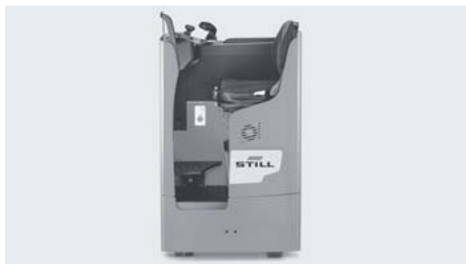
Regulacja wysokości płyty podłogowej dla indywidualnego dostosowania do użytkownika
