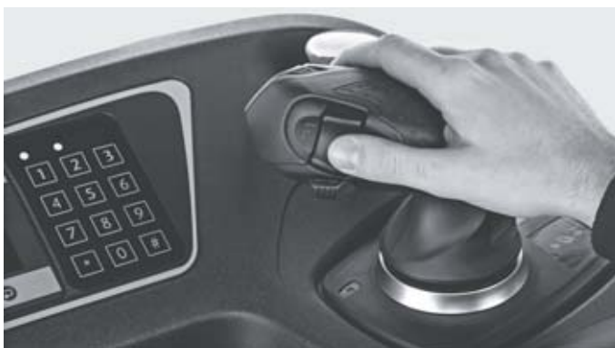
Opcjonalny Joystick 4Plus do sterowania podnoszeniem, opuszczaniem i jazdą bez odrywania rąk
