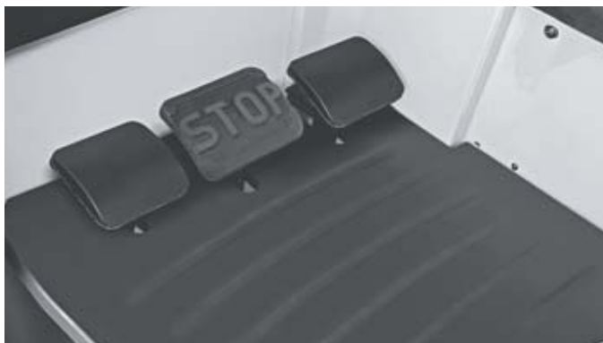
Precyzja aż po czubek stopy: pedały do szybkiej zmiany kierunku jazdy
