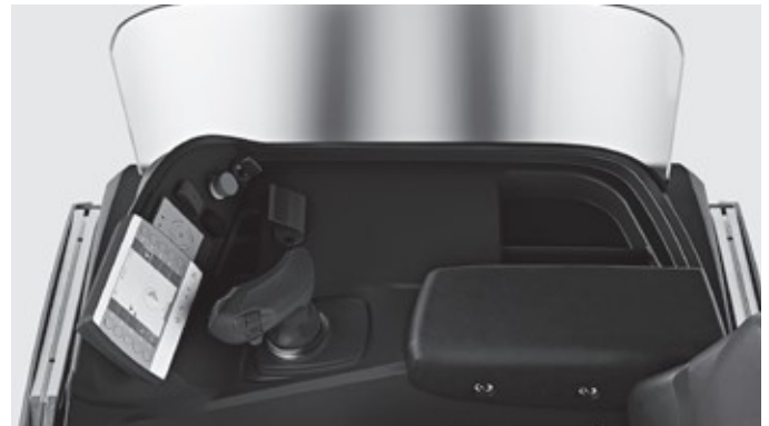
Gestione ad altissima precisione di tutte le funzioni tramite joystick e intuitive indicazione per l'operatore attraverso il display
