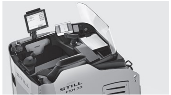
Facilità di posizionamento di un terminale dati (opzionale) e di altri accessori grazie alle guide porta accessori integrate
