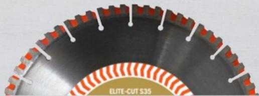
**SPEED BRIDGE** Le disque Elite-Cut S 35 a un pont-raccord entre les segments. Ce système permet d'accélérer la vitesse et la fluidité du sciage par un frottement latéral réduit, un meilleur refroidissement et une évacuation plus efficace de la poussière
