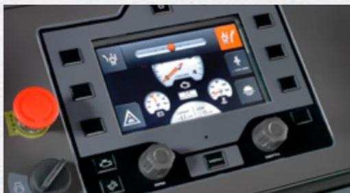
**COUPES RECTILIGNES** Sur les modèles FS 5000 D et FS 7000 D, le tableau de bord comprend un écran de contrôle numérique (ici en mode de suivi électronique) qui facilite le sciage en ligne droite pour une plus grande productivité sans fatigue supplémentaire pour l'utilisateur.
