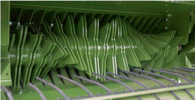
**Высокопроизводительный подающий и режущий ротор**
