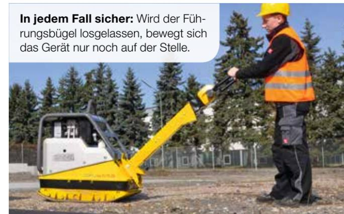
**In jedem Fall sicher:** Wird der Führungsbügel losgelassen, bewegt sich das Gerät nur noch auf der Stelle.
