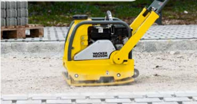
Auskunft über den Verdichtungsfortschritt gibt Ihnen die Compatec-Anzeige bei den Modellen ab 45 kN.
