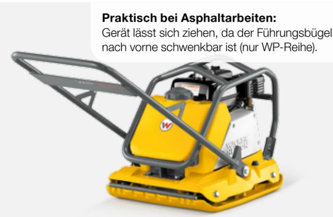
**Spezieller Vario-Erreger** ermöglicht das stufenlose Verstellen der Zentrifugalkräfte, um die Verdichtungskraft individuell an den Boden anzupassen – ideal auch zum Einrütteln von Verbundsteinpflaster.
