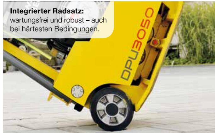
**Integrierter Radsatz:** wartungsfrei und robust – auch bei härtesten Bedingungen.
