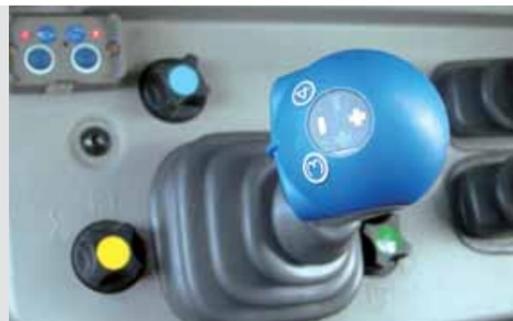
Über den Kreuzschalthebel wird der Frontlader über zwei Steuerventile feinfühlig bedient. Zudem kann ein 3./4. Hydraulikkreis, die hydraulische Werkzeugverriegelung und das Dämpfungssystem bedient werden.
