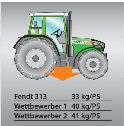
Der 300 Vario kombiniert ein geringes Eigengewicht und kompakte Abmessungen mit den Vorteilen des stufenlosen Fahrtriebes. Das Resultat ist eine hervorragende Dynamik durch ein niedriges Leistungsgewicht von 33 kg/PS und gleichzeitige Bodenschonung im universellen Einsatz.
