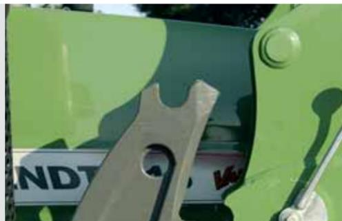
Mit dem Fendt CARGO-Lock bauen Sie den Frontlader schnell an und ab. Die halbautomatische Verriegelung erspart Ihnen das Einsetzen von Verriegelungsbolzen und der Frontlader ist sofort nach dem Einfahren verriegelt.
