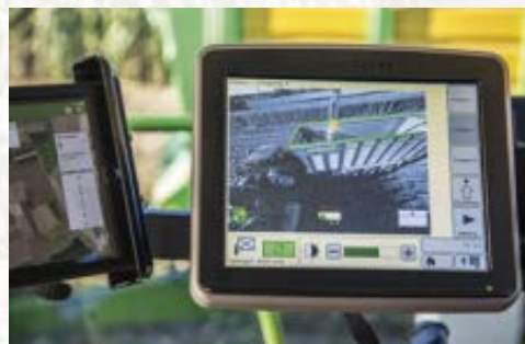
Оператор имеет четкое представление о степени заполнения прицепа
