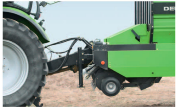
Hydraulische Knickdeichsel für die Modelle AlpMaster 2200 bis FeedMaster 7800. Die hohe Bodenfreiheit von bis zu 600 mm sorgt für sicheres Befahren von Fahrsilos.
