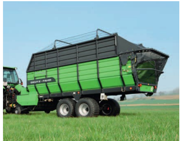
Serienmäßig gefedert und breit bereift: die Tandemachsaggregate.
