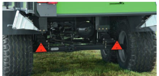
Die stabile gefederte Tandemachse sorgt für hohen Fahrkomfort (FeedMaster 3600T).
