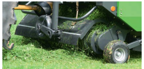
Das serienmäßige Prallblech sorgt für eine gleichmäßige Aufnahme des Futters.
