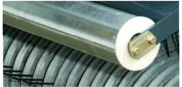
Pickup mit 1,85 m Breite. Nimmt großvolumige, breite Schwaden sicher auf. Der Rollenniederhalter ist serienmäßig (a.W. bei AlpMaster 2200/AlpMaster 2800).
