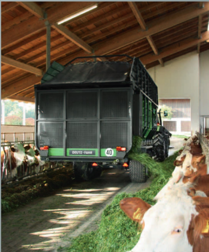
Tägliches Eingrasen durch Querförderband mit Links-/Rechtslauf spart Zeit und Geld.
