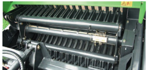
Das leistungsfähige lenkergesteuerte Förderaggregat mit geschmiedeten Doppelfingerzinken.
