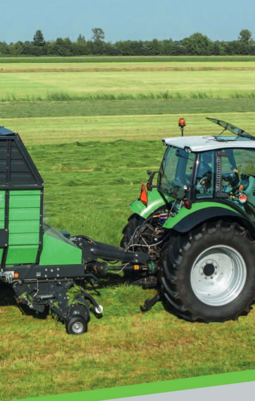
Hydraulische Knickdeichsel für die Modelle AlpMaster 2200 bis FeedMaster 7800. Die hohe Bodenfreiheit von bis zu 600 mm sorgt für sicheres Befahren von Fahrsilos.
