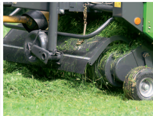
Le Pickup de petit diamètre se glisse aisément sous les andains.
