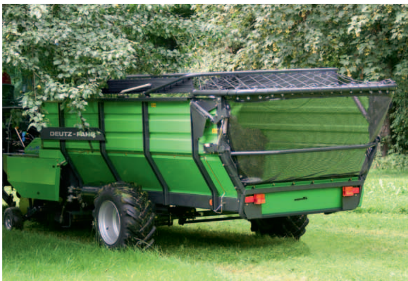
structure pour fourrage sec hydr. pour les modèles AlpMaster et FeedMaster 3000 et 3600 S/T. Adaptation simple de la hauteur de chargement depuis la cabine du tracteur.
