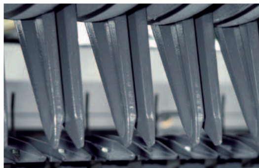
Les dents des peignes convoyeurs assurent une capacité de chargement optimale quel que soit le type de fourrage.
