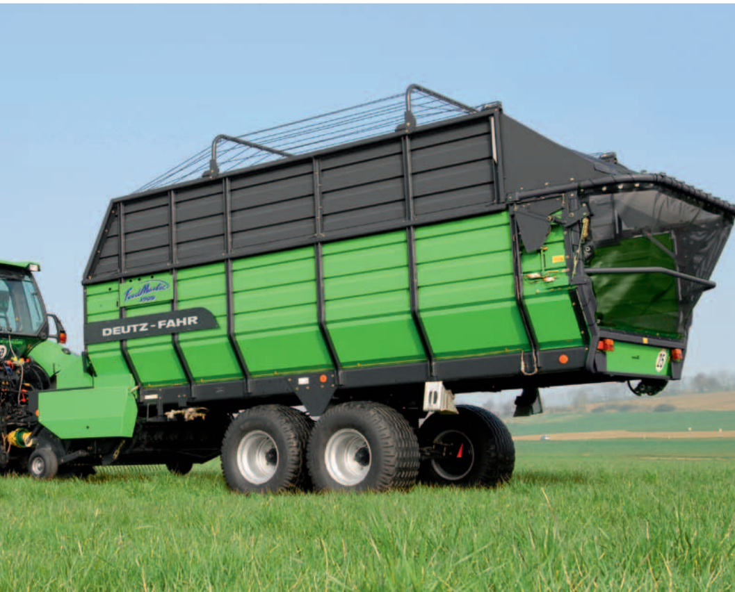
Les essieux tandem sont à freinage hydraulique en série et possèdent de larges pneumatiques.
