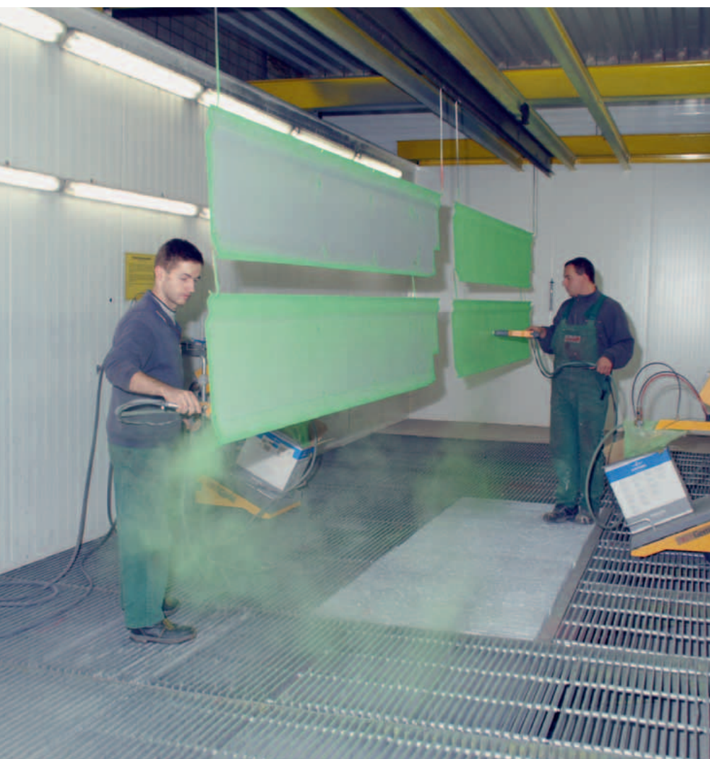
La peinture en poudre de grande qualité protège durablement tous les composants contre la corrosion et l'usure.
