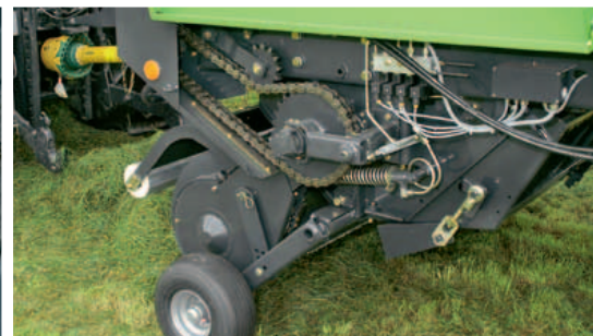
Entraînement robuste et roues de jauge pneumatiques en série garantissent une prise sûre et en douceur.
