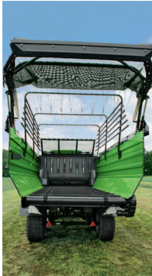
Parois intérieures lisses et structure pour fourrage sec escamotable.
