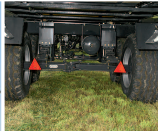
Les essieux tandem sont à freinage hydraulique en série et possèdent de larges pneumatiques.
