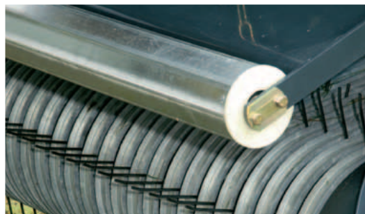
Le rouleau sur la tôle à produit court est en série à partir de FeedMaster 3000.
