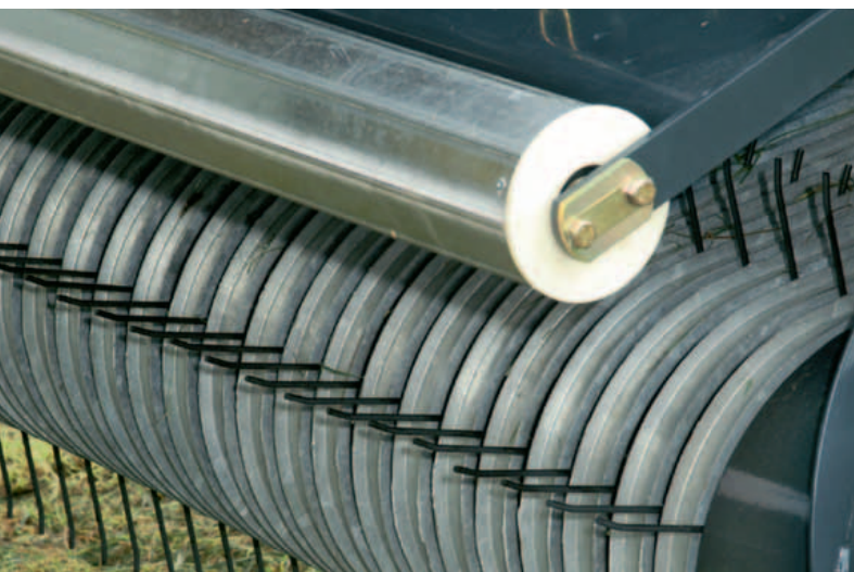
Pickup de 1,85 m de largeur. Prend sans problème des andains de grand volume.
