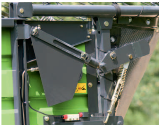
Le hayon est à commande hydraulique en série.
