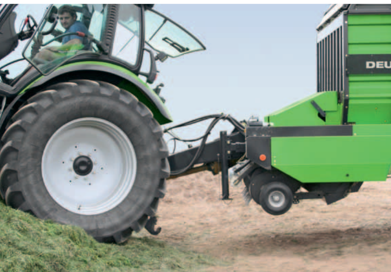
Timon hydraulique pour les modèles AlpMaster et FeedMaster 3000, 3600 et 3900. La garde au sol jusqu'à 600 mm élevée garantit un passage sûr de rampes, talus et d'entrée dans les silos.
