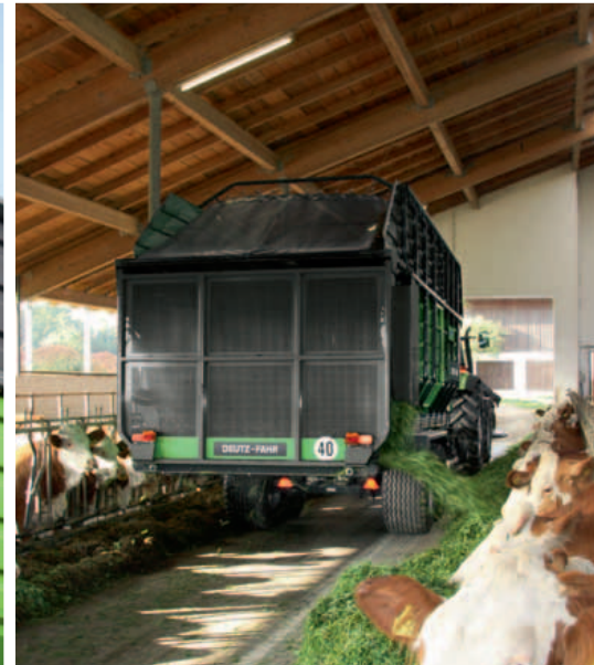
Le tapis de déchargement bidirectionnel permet une décharge sur la gauche ou la droite, ce qui représente une économie de temps et d'argent lorsque les rations quotidiennes comprennent du fourrage frais.
