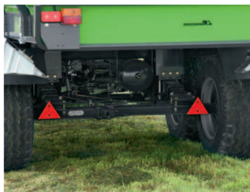
Confort de conduite élevé grâce au robuste essieu tandem à suspension pneumatique. (FeedMaster 3600T).
