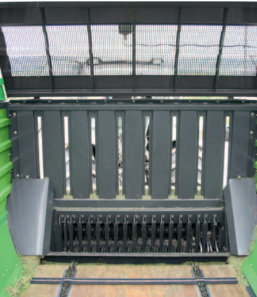
Des parois intérieures lisses garantissent une avance sûre du fourrage.
