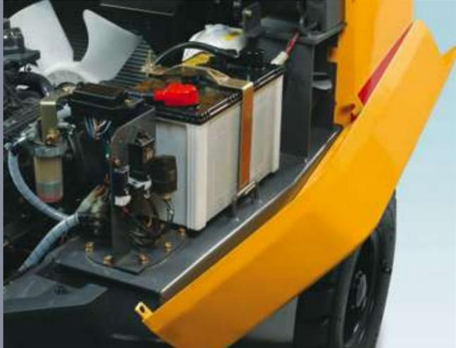
**Abnehmbare Seitenabdeckungen ermöglichen eine zeitsparende Ausführung der Überprüfungs- und Wartungsarbeiten**
