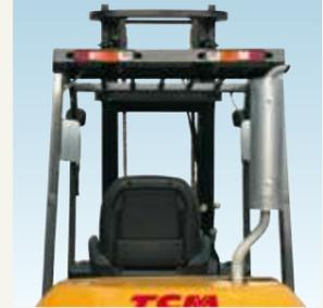
**Auspuffanlage - am Fahrerschutzdach montiert**
