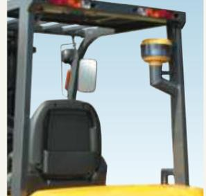
**Vorluftfilter - am Fahrerschutzdach montiert**
