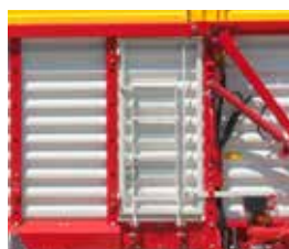
Deur met ladder
