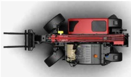
Hundeganglenkung: Hundegang - Seitliches Fahren in gerader Linie, beispielsweise für Arbeiten direkt neben einer Mauer.
