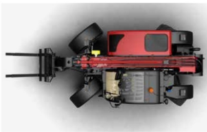
Allradlenkung: Minimaler Wendekreis und maximale Wendigkeit.
