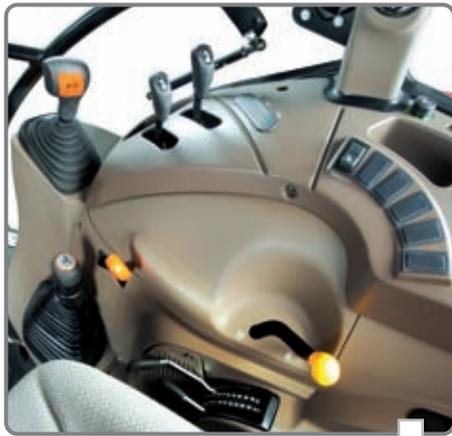
**Facilità d'impiego**, grazie alla disposizione intuitiva ed ergonomica dei comandi sulla console di destra e sul montante posteriore destro.
