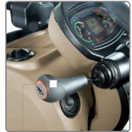
**Powershuttle**. Al semplice tocco di una leva, l'inversore idraulico permette di arrestare e invertire la marcia per una manovrabilità rapida e agevole.
