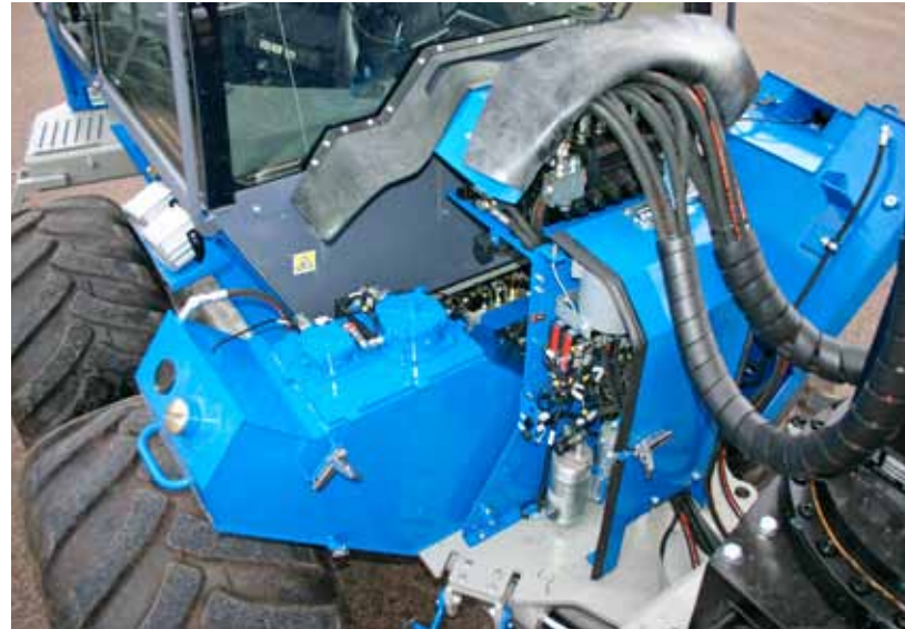
Hydraultanken fälls ut vid filterbyte
