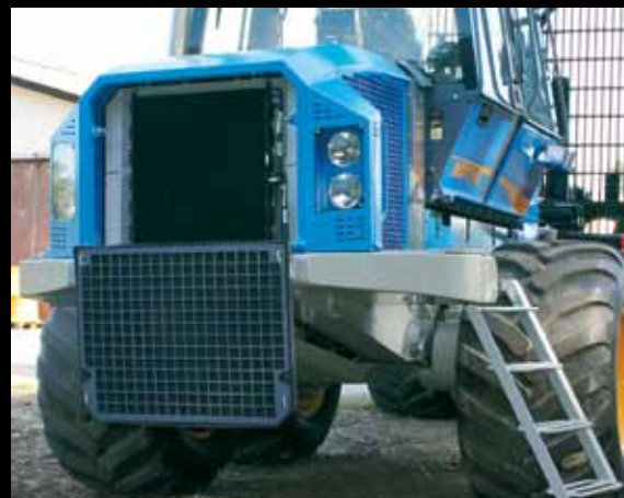
Otwierany przód maski silnika
