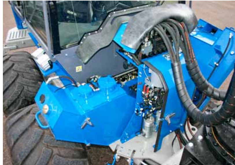
Przy wymianie filtra odchyła się zbiornik hydrauliczny
