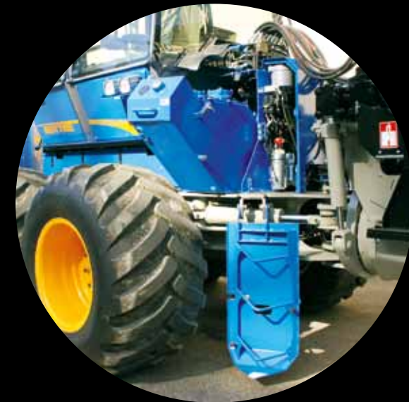
Treppenleiter im schutzhaube eingebaut
