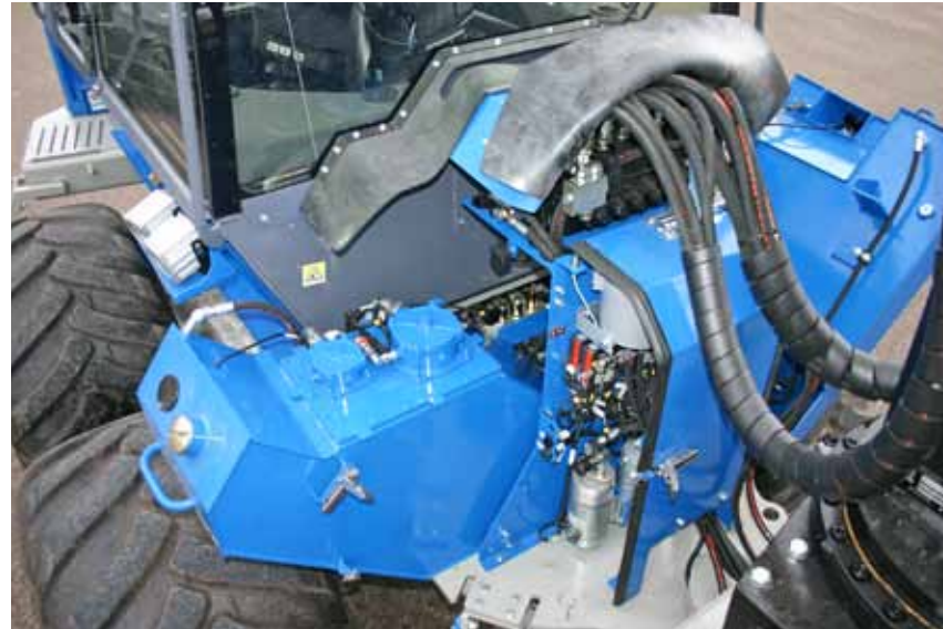
Der Hydrauliktank wird seitlich weggekippt für Filterwechsel
