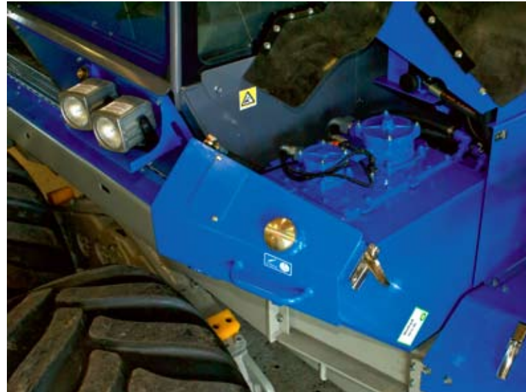
Für einen einfachen Filterwechsel wird der Hydrauliktank seitlich weggeklappt.
