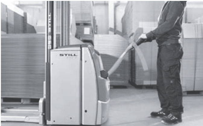
Безопасность: в зависимости от угла положения дышла скорость движения автоматически адаптируется к расстоянию между оператором и тележкой
