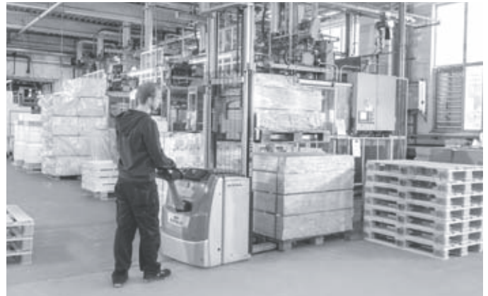
Высокая производительность за счет транспортировки грузов в два яруса
