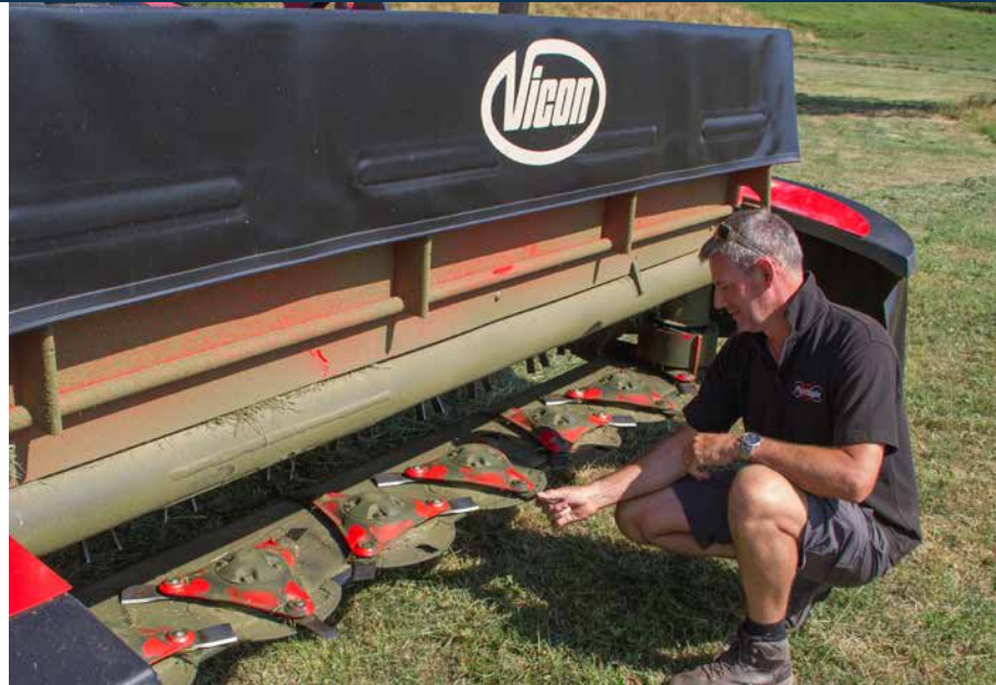
De frontkap kan verticaal omhoog klappen voor eenvoudige toegang.
