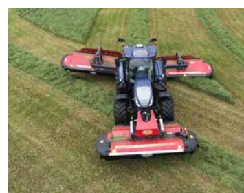
Bij gebruik van één band wordt snelheid vertraagd, zodat er geen gras over het zwad wordt gegooid.
