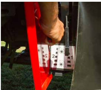
Dubbele verstelling van de kneuzerplaat voor de juiste kneusintensiteit.
