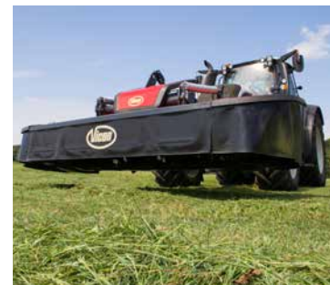
Ruime kopakkerpositie van maar liefst 420mm zonder het verstellen van de frontheft.
