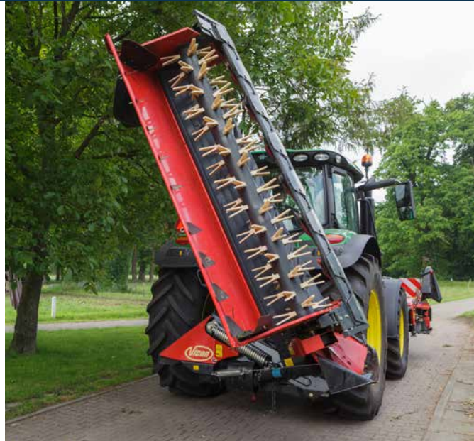
125° transportpositie zorgt voor een transporthoogte onder de 4m.
