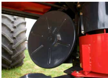
De machine kan optioneel worden voorzien van 2 zwadschijven, die een zwadbreedte van resp. 2,0 - 2,2 -2,4 m mogelijk maken.
