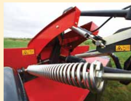
Odciążenie sprężynowe z regulacją
