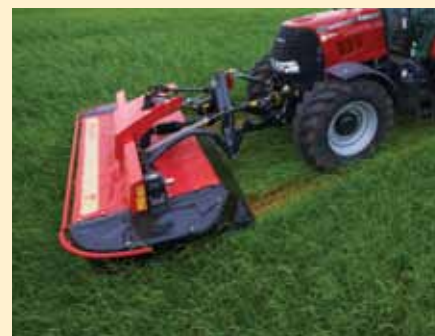
Pływające zawieszenie w kosiarce czołowej
