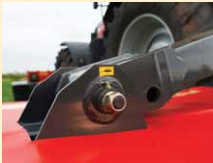
Regulacja rozstawu oraz centralne zawieszenie tylnych kosiarek
