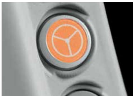
Die hydraulische Feststellbremse (Park Brake) dient zum sicheren und effizienten Abstellen des Traktors unter allen Bedingungen, auch in bergigem Gelände. Dadurch ist maximale Sicherheit jederzeit gewährt.
