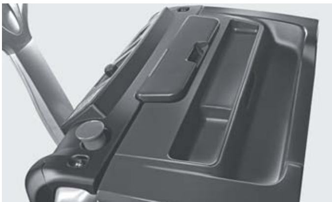
Freie Hände: Praktische Ablagefächer und eine Schreibunterlage mit integrierter Papierklemme 1,2
