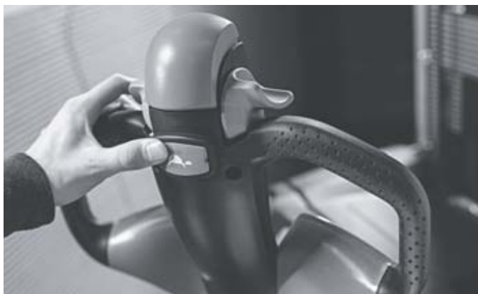
Präzise in jeder Situation: Dank Schleichfahrtschalter ist es auch möglich, in engsten Räumen zu manövrieren 1,2
