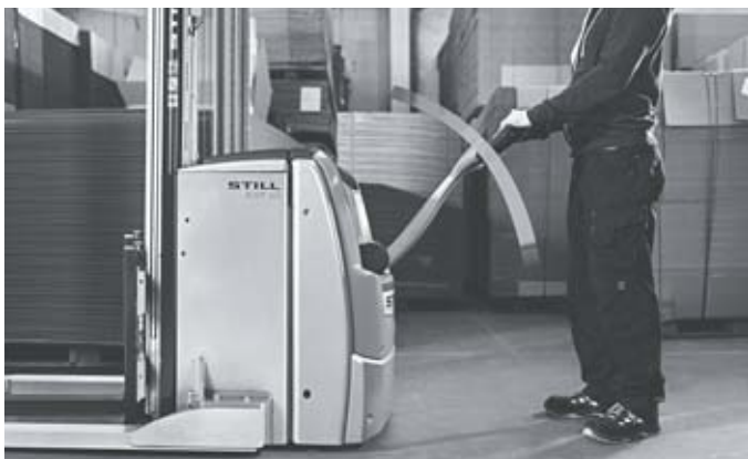
Sicherheit in Serie: Geschwindigkeit passt sich deichselwinkelabhängig automatisch an den Abstand des Fahrers zum Fahrzeug an (OptiSpeed) 1,2
