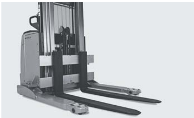
Alleskönner: Freitragende und verstellbare Gabelzinken erlauben das Handling von unterschiedlichsten Palettenarten 1,2
