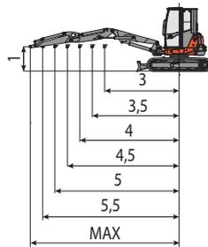
Hebekraft basierend auf ISO-Norm 10567 und überschreitet nicht mehr als 75% der Kipplast oder 87% der hydraulischen Hebe-Kapazität der Maschine.
