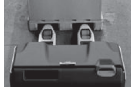
Praktische Linienführung für gute Sicht auf die Gabelspitzen
