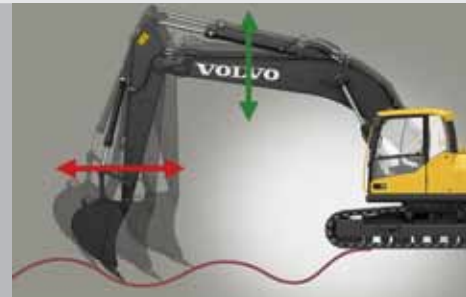
Fonction de flottement de la flèche
