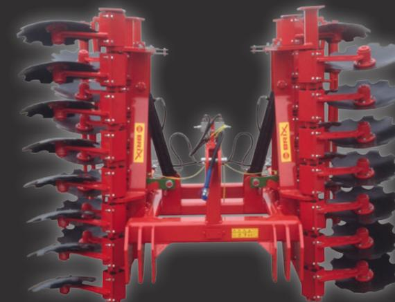
Die 2-teilige Bauweise der EcoDisc erlaubt das Abstellen im geklappten Zustand. Die Transportbreite beträgt 2,70 Meter.
