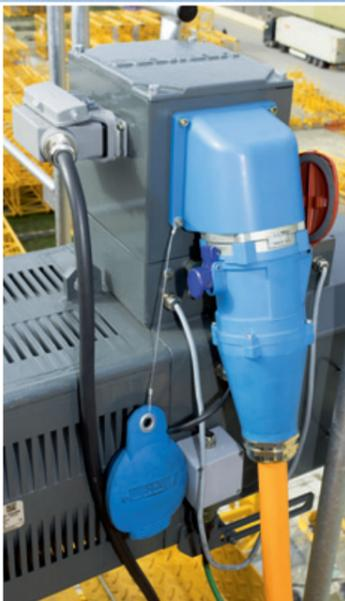
Enchufe eléctrico del mecanismo de elevación
