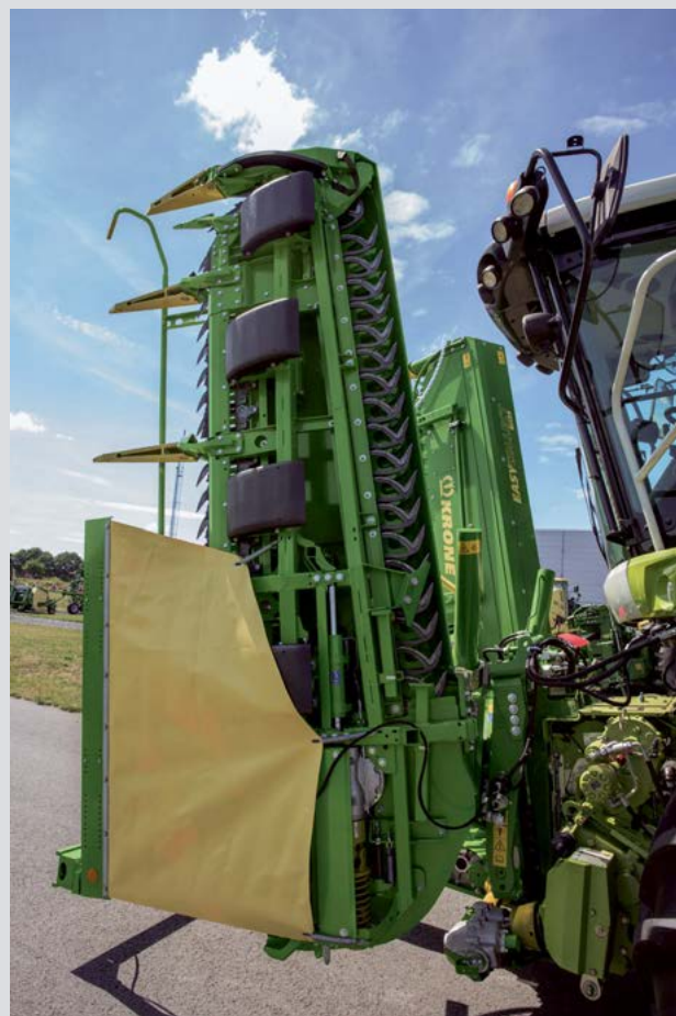
2-секционная: 2-Секционная кукурузная приставка имеется с ширинами захвата 4,5 м, 6 м и 7,5 м.
