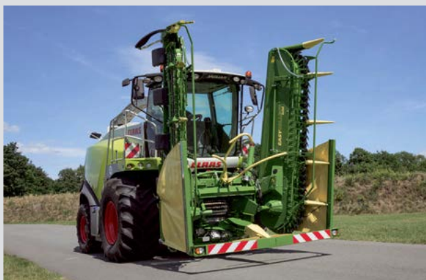
2-секционная: 2-Секционная кукурузная приставка имеется с ширинами захвата 4,5 м, 6 м и 7,5 м.
