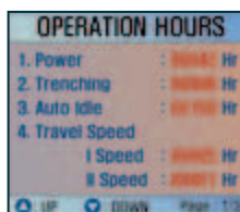
Betriebsstundenanzeige in den versch. Betriebsbereichen
